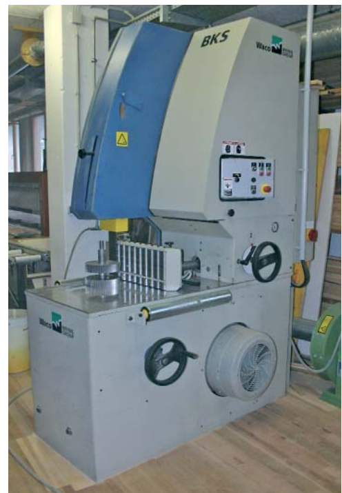
Robuste Bauweise der Waco BKS-Trennbandsäge FOTOS: NÖSTLER
